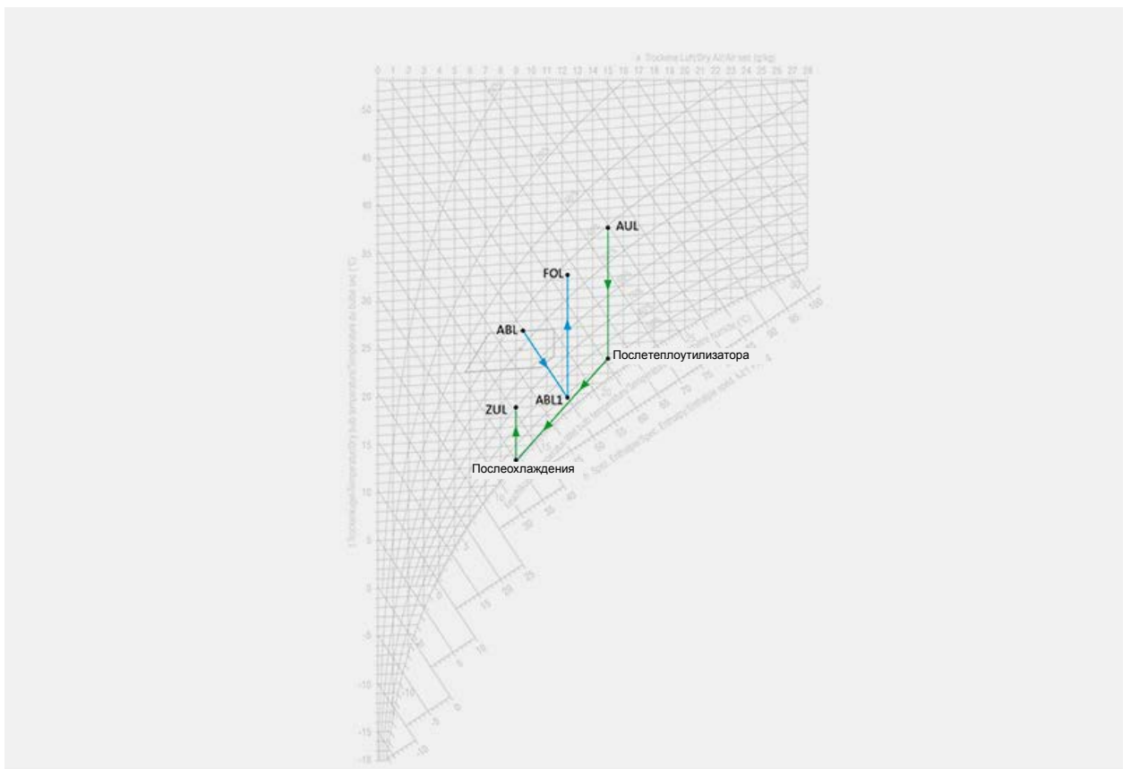
Рис. 2: качественное представление термодинамического процесса на психрометрической диаграмме.
